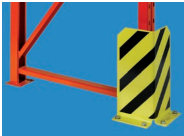
Eckschutz MF400 , L-Form, starr, stabiles, winkelförmiges Profil, mit kräftiger Bodenplatte, einschließlich 4 Anker zur Befestigung im Hallenboden. Farbe RAL 1018
