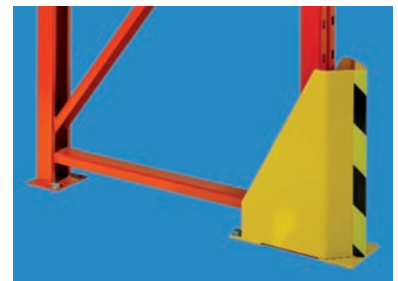
Anfahrtschutz GIB1 , U-Form, starr, trapez, zum Schutz der Regalstützen gegen Beschädigungen durch Flurförderzeuge, 140 mm breit, U-förmig, einschließlich 3 Bodenanker. Farbe RAL 1023
